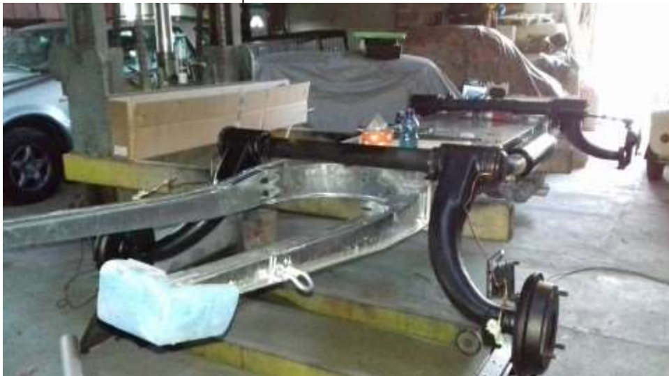
Mardi fin de la crémaillère remplacement des soufflets et contrôle des leviers de barre de direction
