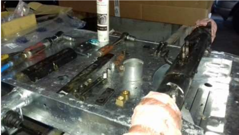
La crémaillère est démontée avec remplacement des supports de rotules
