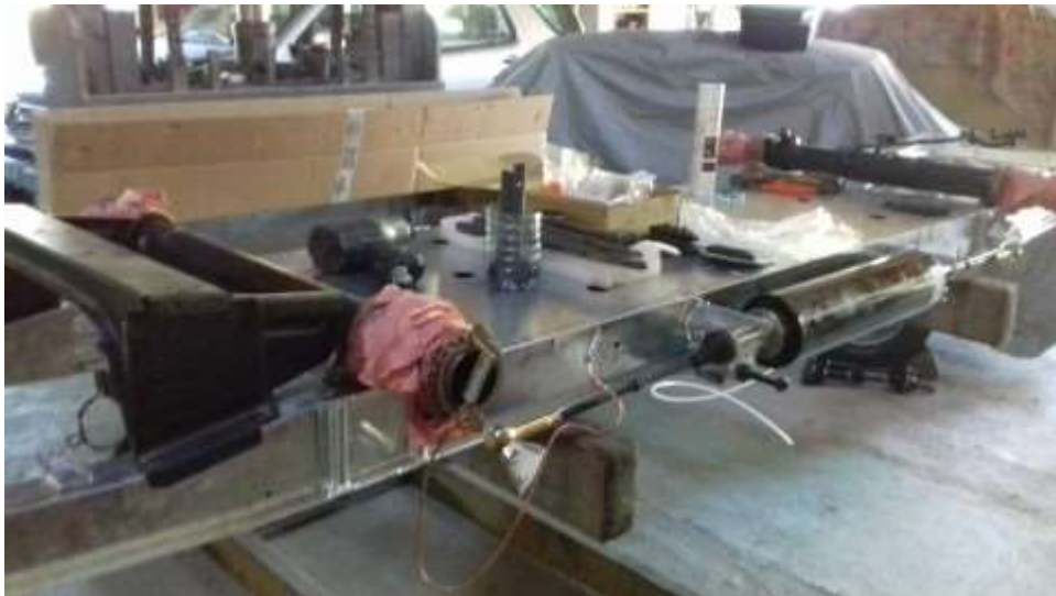
Mardi fin de la crémaillère remplacement des soufflets et contrôle des leviers de barre de direction
